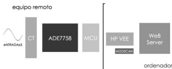
Figura 2: Diagrama de bloques del dispositivo remoto para medición y monitoreo de consumo de energía eléctrica
