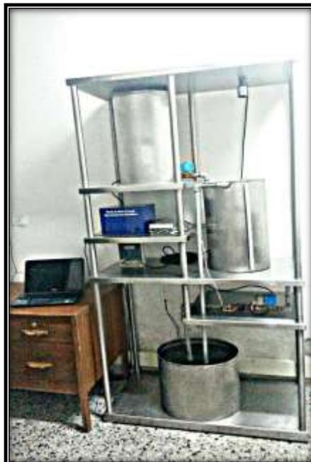
En la *Figura 20* se muestra el esquema de la planta, la cual consta de tres tanques; tanque de perturbación de nivel T1, tanque principal T2, tanque de reserva T3, dos electroválvulas proporcionales; electroválvula de perturbación V1, electroválvula de control V2 y una bomba sumergible B1, un sensor de nivel S1 ubicado en la parte superior de T2 y un sensor de caudal S2 ubicado en la tubería inmediatamente después de V2.
