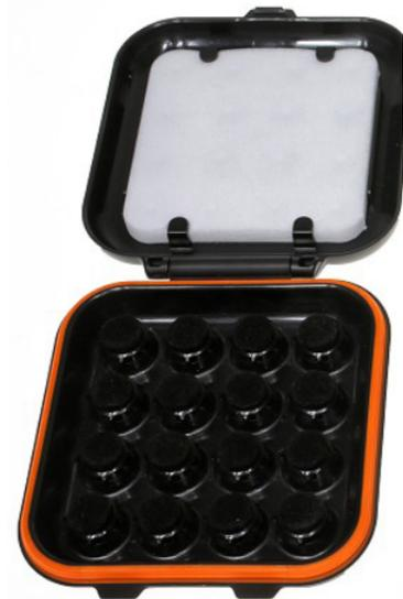
primera versión del EPOC EMotiv con la caja de los electrodos y sus esponjas que absorben el conductor salino. Fuente: Emotiv Inc. *EPOC Emotiv*. (Consultado 11/29/2015).
