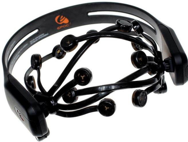
Figura 4. Electrodo a base de conducción salina del Emotiv EPOC
