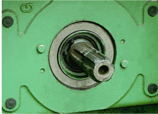
Figura 2. Toma de fuerza (PTO) en la parte trasera de un tractor agrícola.
