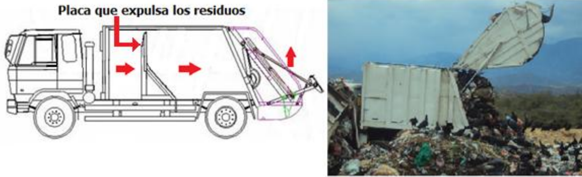
Figura 2. Sistema de descarga de residuos sólidos.
