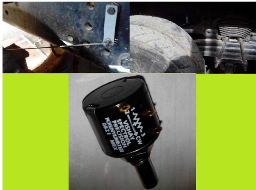
Figura 11. Implementación del potenciómetro de prueba.
